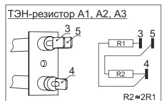
Рисунок 5. Электрическая схема завесы КЭВ-36П7021Е
