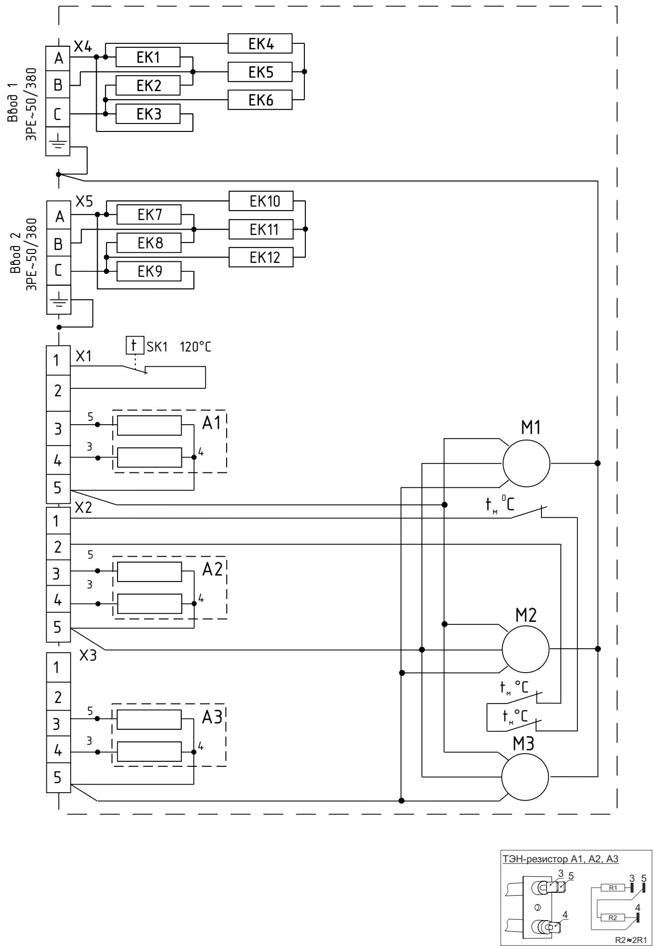
Рисунок 7. Электрическая схема завесы КЭВ-60П7021Е
