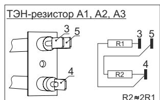
Рисунок 4. Электрическая схема завесы КЭВ-42П7011Е
