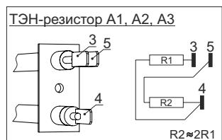
Рисунок 6. Электрическая схема завесы КЭВ-48П7021Е
